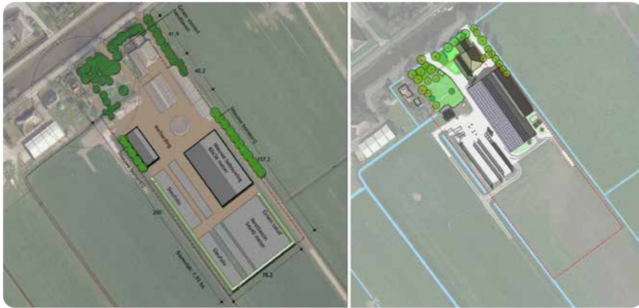
Oud plan met de uitbreiding achter op het erf en huidige situatie met de overkapping van bestaande schuren (zelfde schaal)
